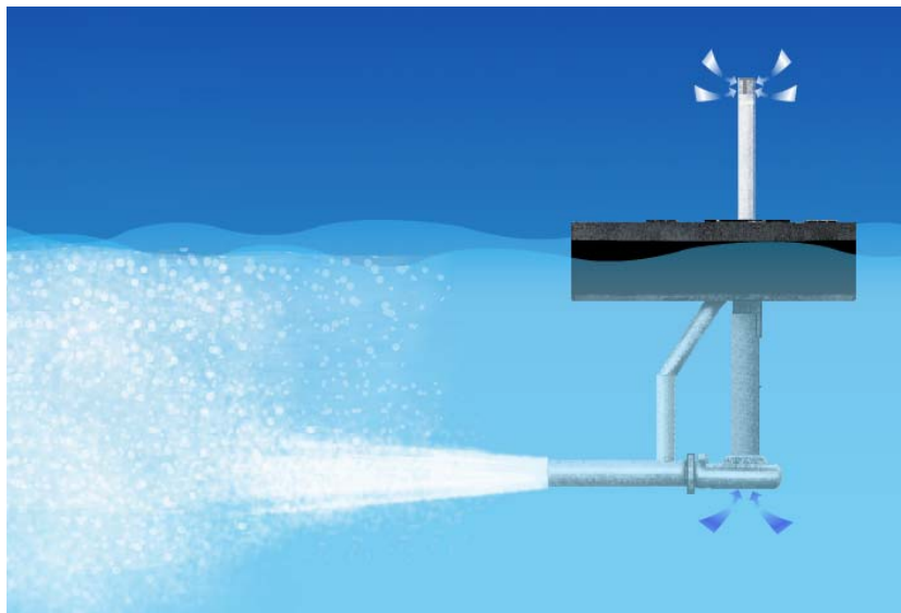
รูปที่ 4 ระบบเติมอากาศแบบเวนจูรี่ชนิดติดตั้งกับทุ่นลอย
